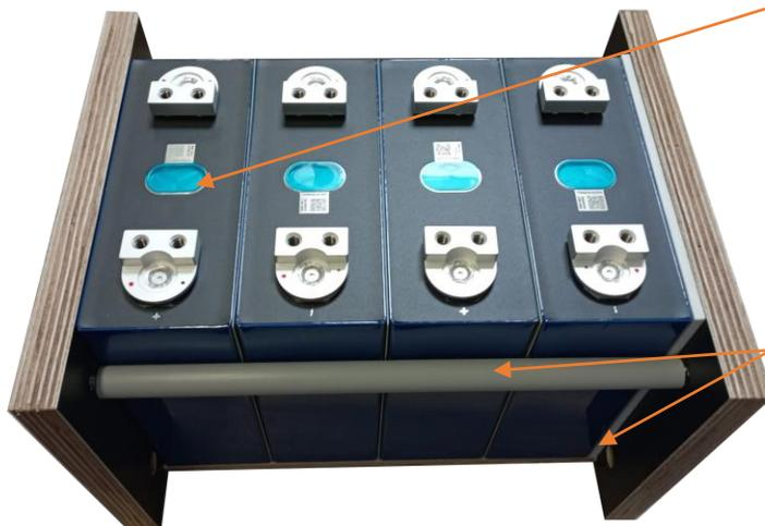
**2.** Setze nun Deine 4 Zellen ein, zwischen 2 Zellen kommt immer eine gelbe Isolierscheibe. Die Weiße Platte neben den Zellen ist für die Druckkompensation da!
