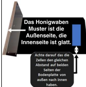
**1.** Platziere die Bodenplatte und erste Seitenwand, positioniere die Zellen. Die Bodenplatte wird später verschraubt (siehe Schritt 6). Kippe das Batteriepack oder ziehe den Akku über die Tischkante, um an die Löcher zu gelangen (Gewindestangen sind bereits angezogen)
